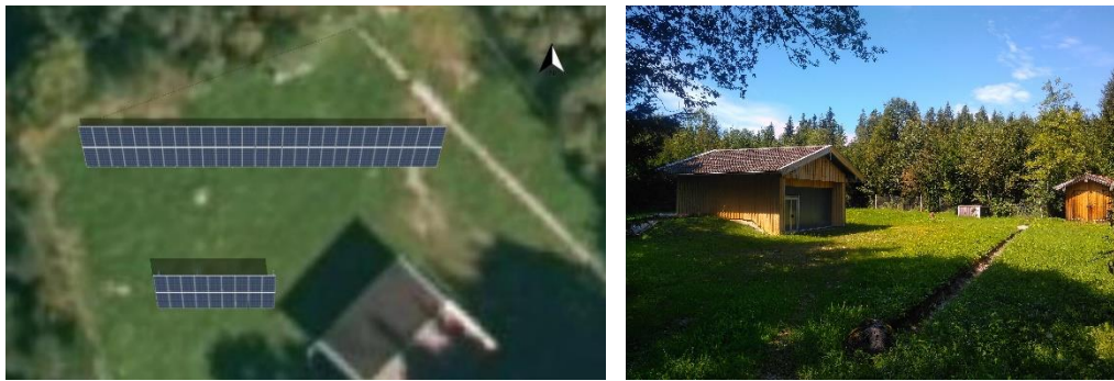
Abbildung 5-4: Simulation einer PV-Freiflächenanlage am Pumpwerk Fuchsloch (links). Ansicht des Geländes Richtung Nordwesten (rechts).
